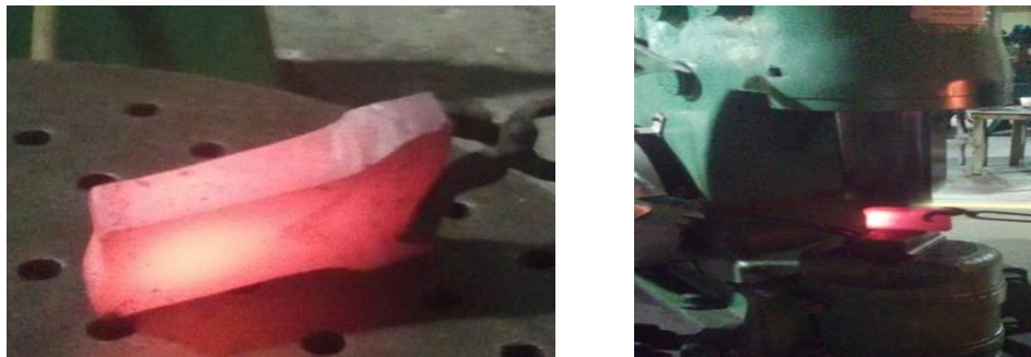
Figura 4a y 4b. Proceso de forja de las bielas
